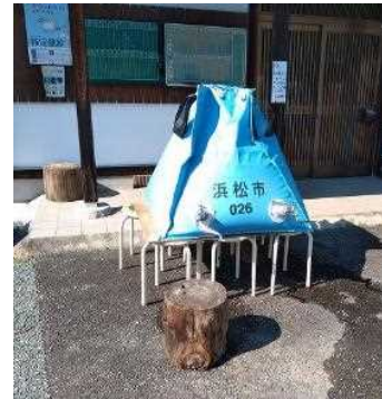
〔浜松市の仮設水槽〕
