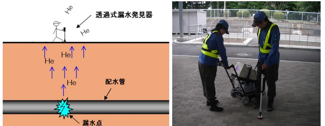
図 27 透過式漏水発見器
