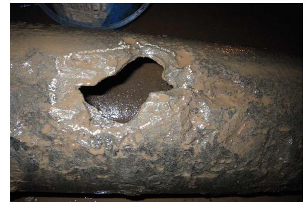
図 2 鋳鉄管の腐食漏水
