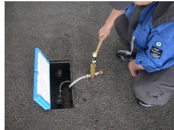
図 29 打撃音注入器
