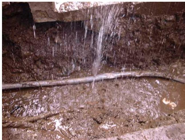
図 11 鉛製給水管の漏水状況
