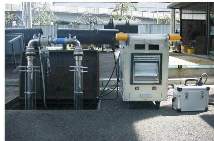
図 20 最小流量測定装置
