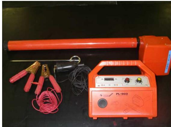
図 28 金属管探知器
