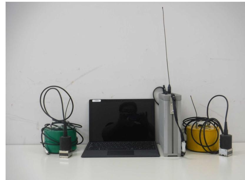
図 25 相関式漏水発見装置
